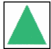
• Triângulo ou retângulo verde Pilar de ponte à direita de quem sobe ou desce o rio
